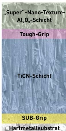
.....  $Al_2O_3$ -Schicht mit ausgezeichneter Verschleißfestigkeit.
