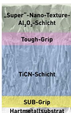
.....  $Al_2O_3$ -Schicht mit ausgezeichneter Verschleißfestigkeit.
